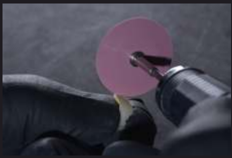
2 Rifinitura abrasiva media dei margini e superfici omogenee Smoothing of edges and surfaces
